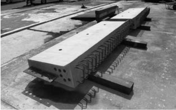
写真-4 プレキャスト壁高欄の完成写真
